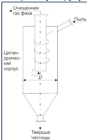
Перепад давления в циклоне  $\Delta P = 1000$  Па, плотность газа  $\rho = 1,3$  кг/м<sup>3</sup> коэффициент сопротивления циклона  $\xi = 100$ , объемный расход газовой фазы  $2,2$  м<sup>3</sup>/с. Определить диаметр циклона.
